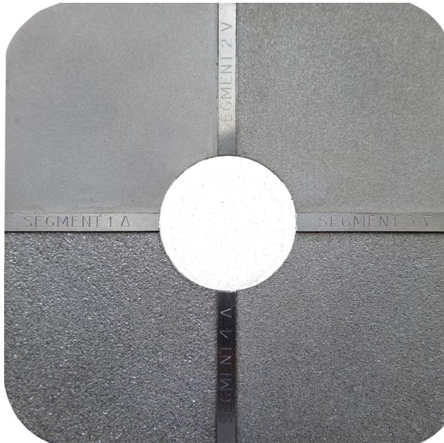
Rauheitsnennwerte der einzelnen Segmente eines Komparators
