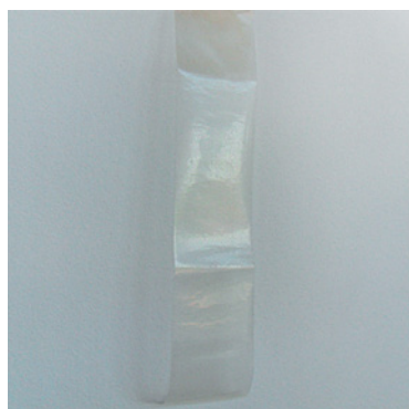
2.11 Test d'arrachage au ruban adhésif
