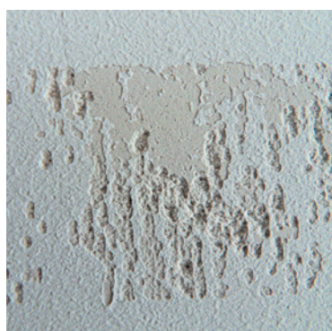
2.11 Test d'arrachage au ruban adhésif
