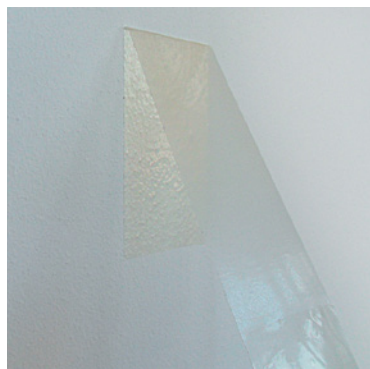
2.11 Test d'arrachage au ruban adhésif
