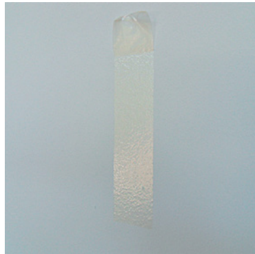
2.11 Test d'arrachage au ruban adhésif
