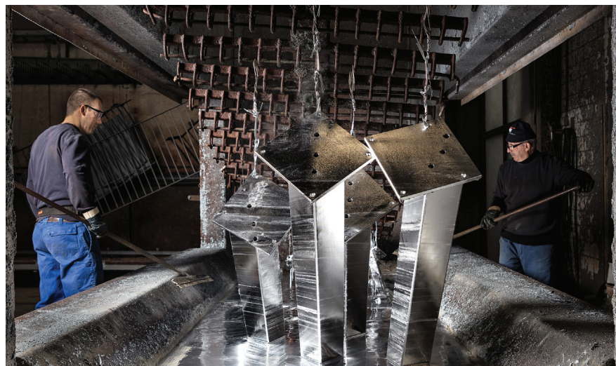
Die Kombination des Feuerverzinkens mit der Pulverbeschichtung im Duplex-Verfahren sorgt für einen besonders hohen Korrosionsschutz.
